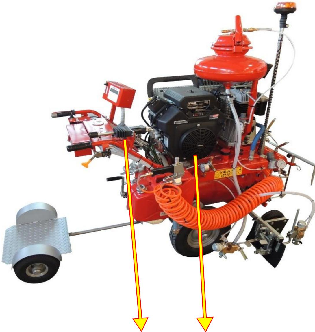
**Motore maggiorato da 20.5 HP applicato alla trazione semovente idraulica tramite pompa a portata variabile (P.P.V.)**
